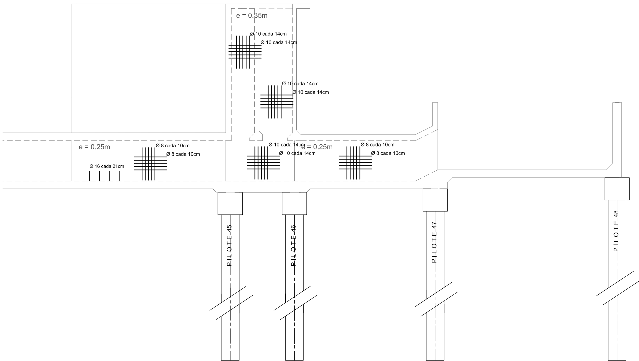
TABIQUE 13 - Armadura Cara Sur
