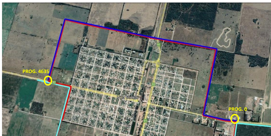
Figura N° 39: Traza Canal Exterior Norte (a construir)
