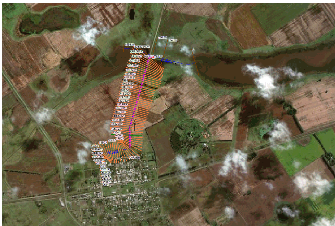
Esquema planimétrico – Modelación HEC-RAS
