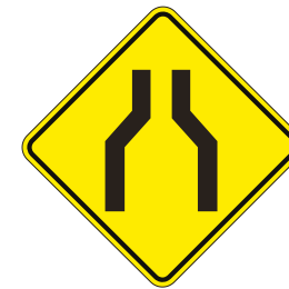
Estrechamiento (en las dos manos) P 10
