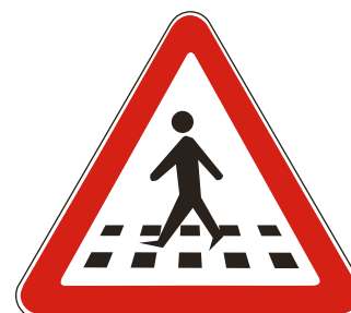
Cruce de peatones P5
