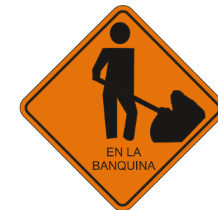
Trabajos en la banquina T8
