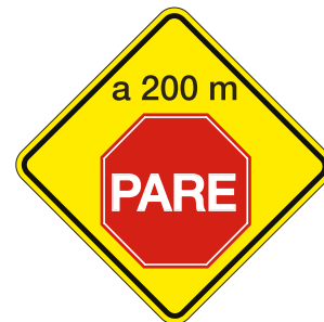
Proximidad de señal restrictiva (pare) P 33
