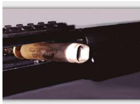
**Doble Alimentación:** esta falla se da por lo general, cuando la uña extractora presenta un desperfecto o no se logra completar el recorrido del guardamano móvil. Si se logra solucionar la interrupción y al momento de ejecutar nuevamente la acción de carga y descarga, se podrá continuar. Si no, indefectiblemente se deberá optar por su reemplazo.
