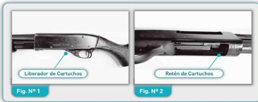
**Armazón o Cajón de Mecanismo** El armazón se encuentra en el centro del arma, el mismo cumple la función de contener varias piezas fundamentales (martillo, cerrojo, entre otras) como así también la conexión del tubo cañón, el almacén cargador y la culata del arma. En ella se observan el arco guardamonte, la cola del disparador y el liberador del guardamano móvil y el seguro.
