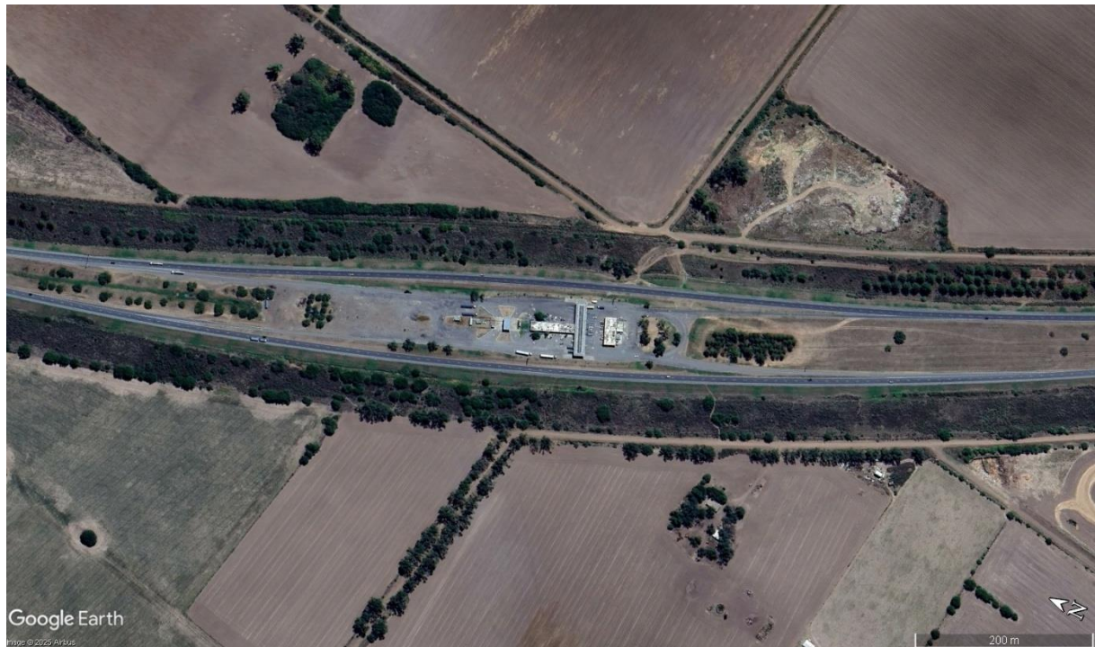
Figura 18. Imagen satelital de ubicación de estación de servicio sobre la mediana y configuración de ramas de ingreso y egreso. Fuente: Google Earth.
