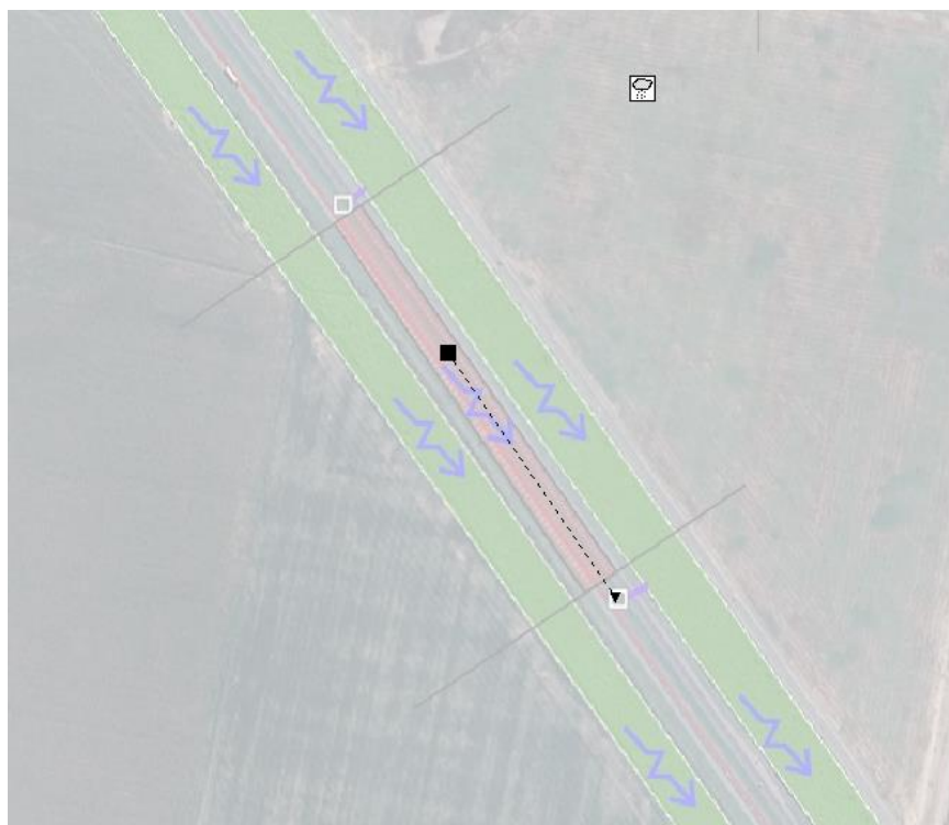
Figura 4.9 – Esquema topológico de simulación. Modelo SWMM.
