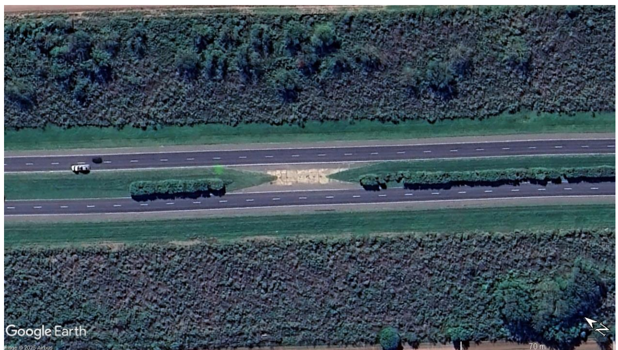
Figura 26. Imagen satelital geometría de los retornos emplazados en las medianas.
