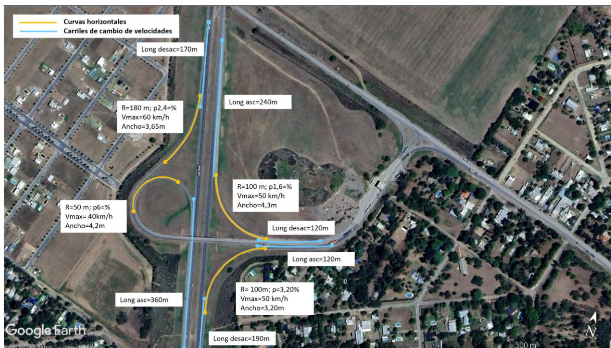
Figura 23. Esquema y análisis de geometría y velocidades máximas en intercambiador entre AP01 y RPN°91. Fuente: Google Earth.
