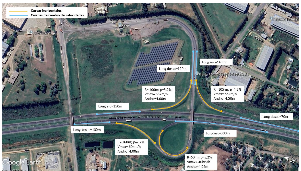
Figura 8. Esquema y análisis de geometría y velocidades máximas en intercambiador entre AP01 y RPN°10. Fuente: Google Earth.
