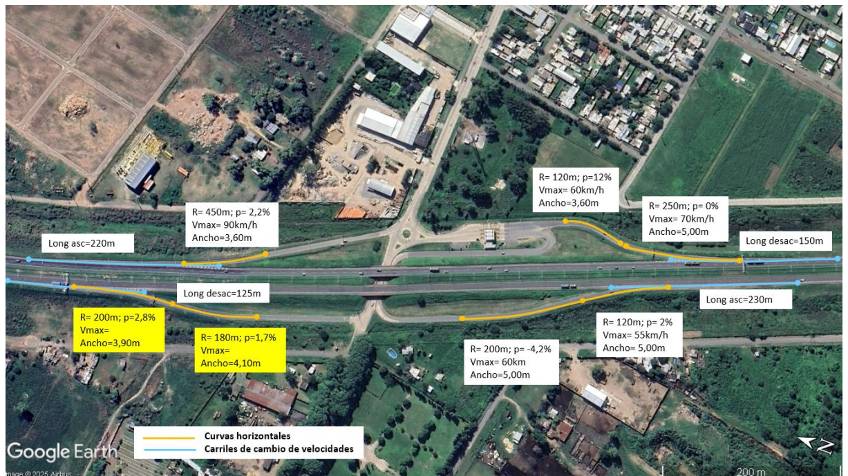
Figura 4. Esquema y análisis de geometría y velocidades máximas en intercambiador entre AP01 y acceso a San Lorenzo Centro. Fuente: Google Earth.
