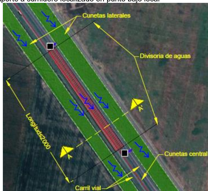
Figura 4.5 – Área de Aporte a sumidero localizado en pendiente continua
