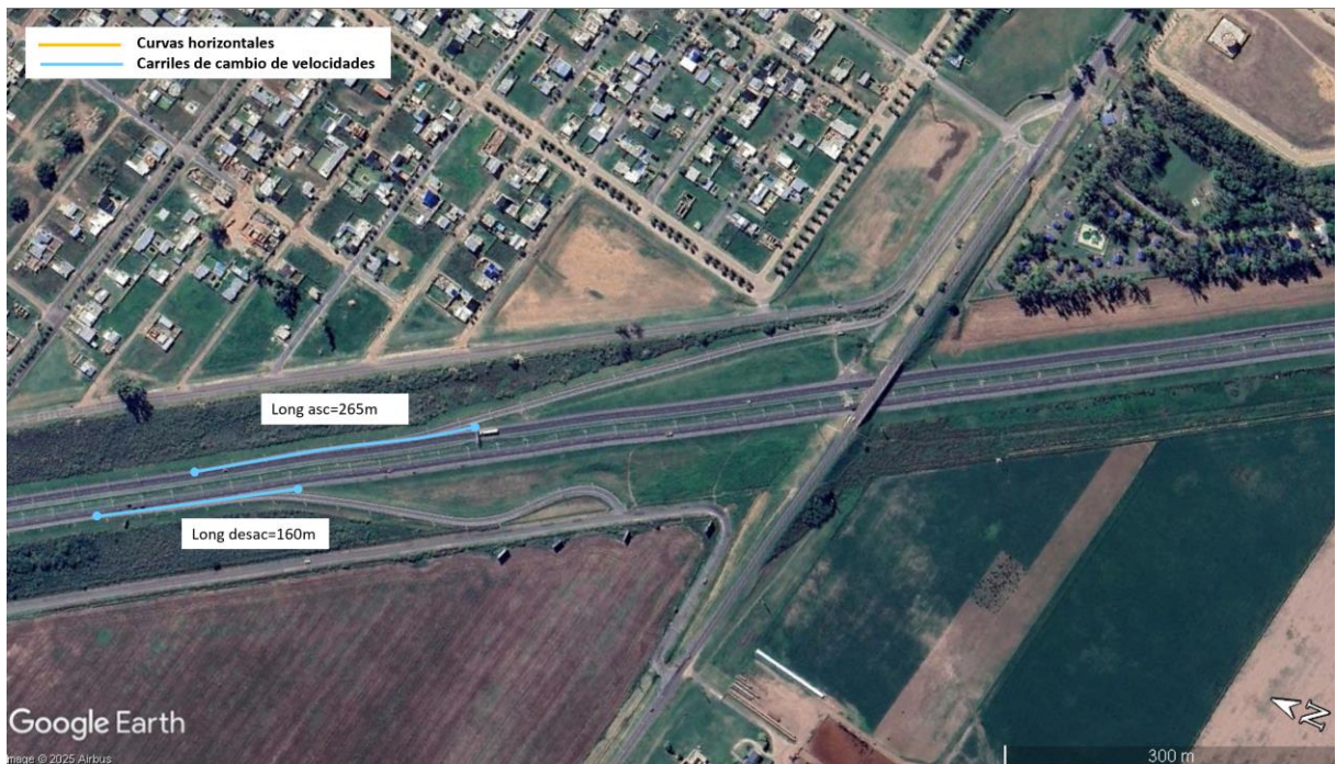
Figura 12. Esquema y análisis de carriles de cambio de velocidad en acceso a RPN°18s. Fuente: Google Earth.
