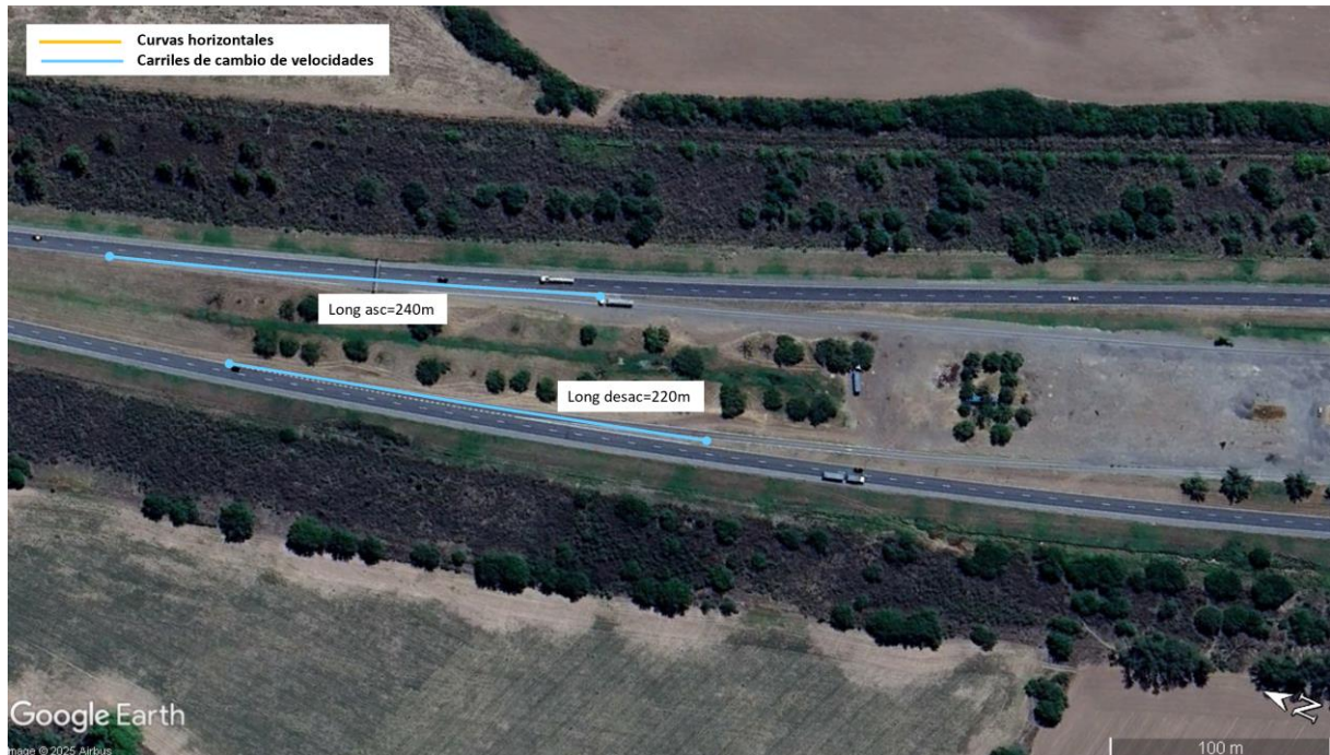
Figura 20. Esquema y análisis de geometría y velocidades máximas en ramas de ingreso y egreso aguas abajo de estación de servicio en pk 27+000. Fuente: Google Earth.
