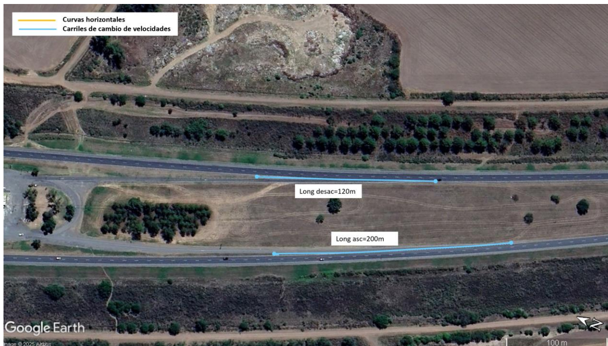
Figura 19. Esquema y análisis de geometría y velocidades máximas en ramas de ingreso y egreso aguas arriba de estación de servicio en pk 27+000. Fuente: Google Earth.
