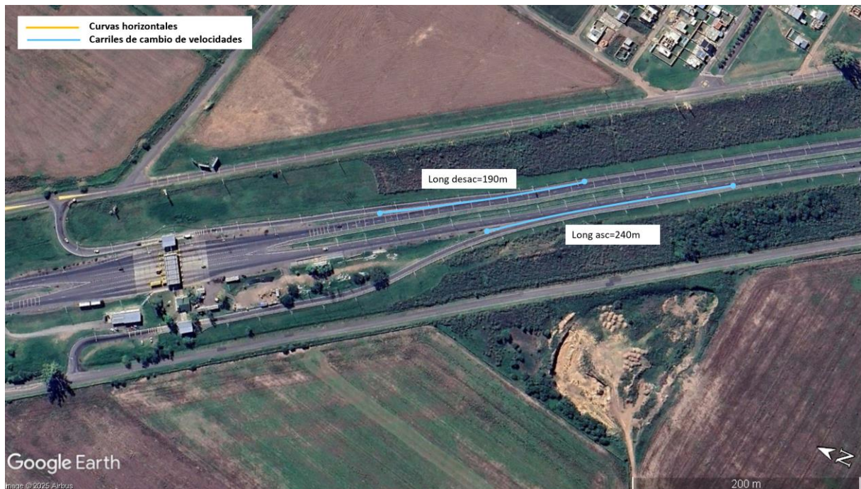
Figura 13. Esquema y análisis de carriles de cambio de velocidad en acceso a localidad de Puerto San Martín. Fuente: Google Earth.
