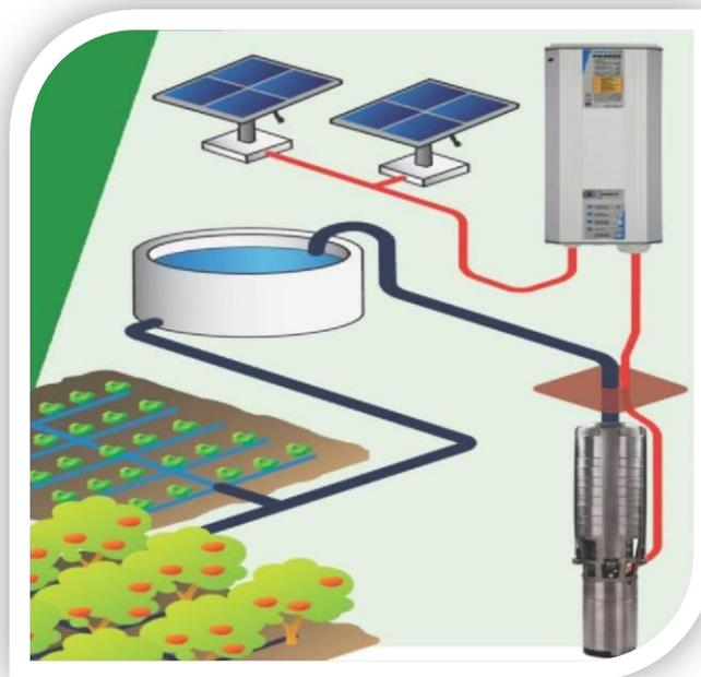
*Ilustración 1: sistema autónomo sin baterías.*
