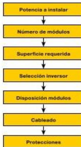
Ilustración 22: Esquema de diseño de un sistema de generación fotovoltaico
