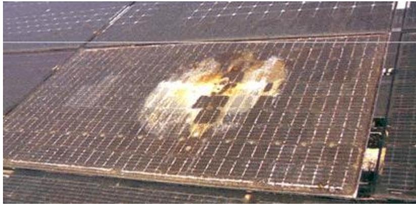
Ilustración 6. Punto caliente o hot spot en panel solar
