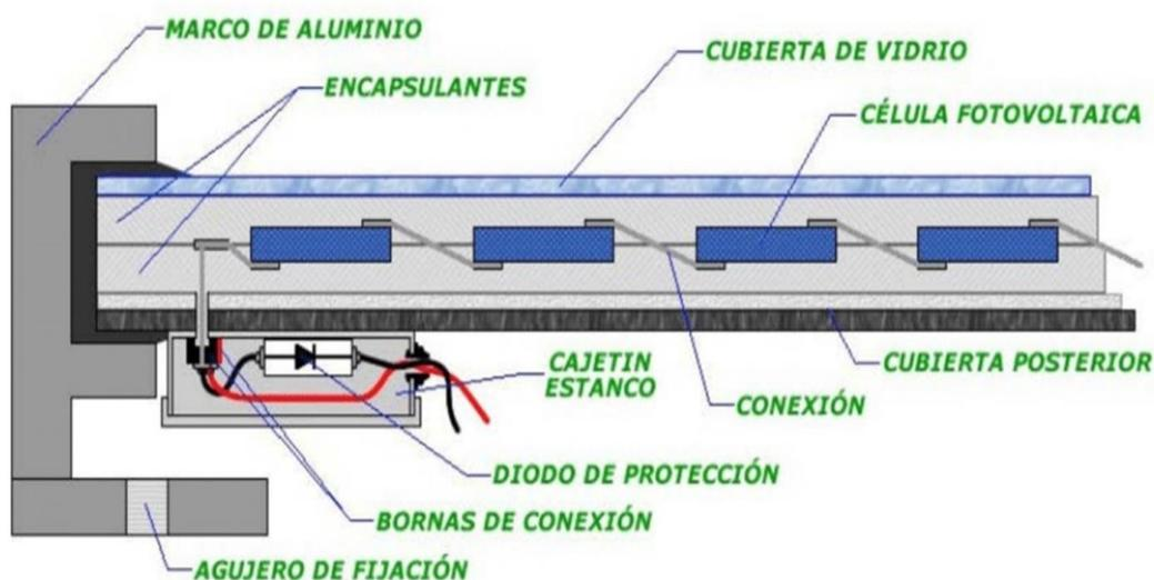
Ilustración 8. Diodo de protección en el panel solar fv
