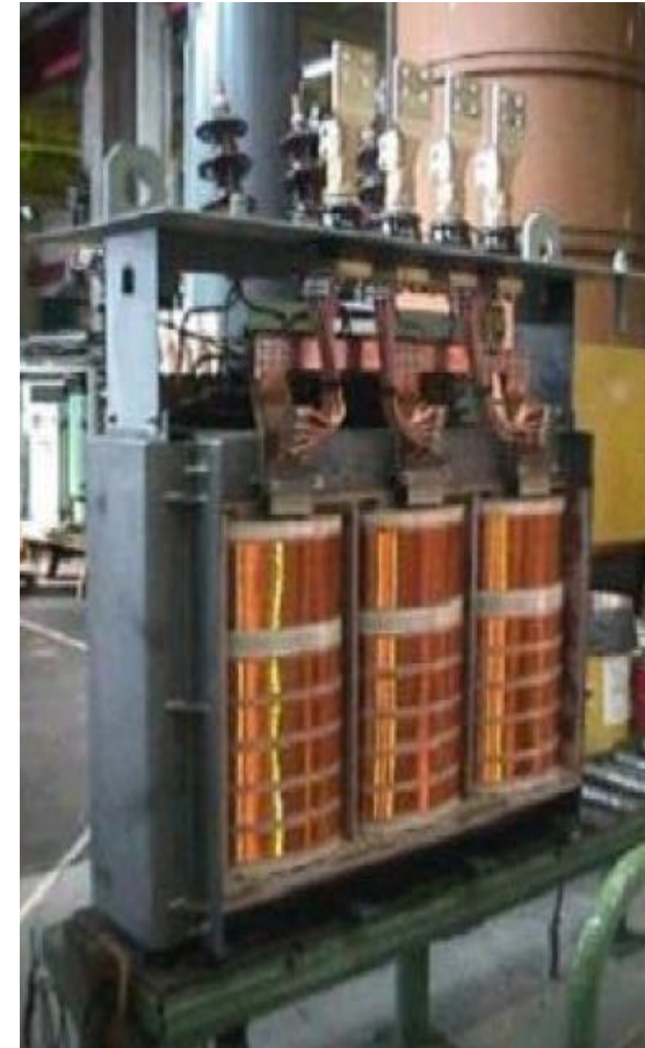
Transformador sin su Cuba
