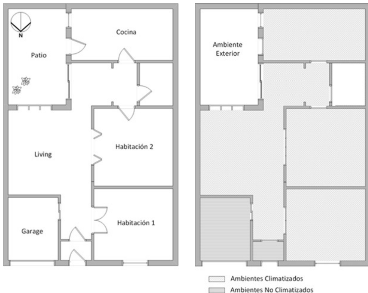
Figura A.2: Planta del inmueble identificando ambientes climatizados y no climatizados
