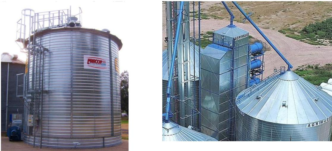
*Figura 3: Ejemplo de secado con aire natural y/o baja temperatura SSAN/BT-INTA (izq) y con secadora de gas (der)*
