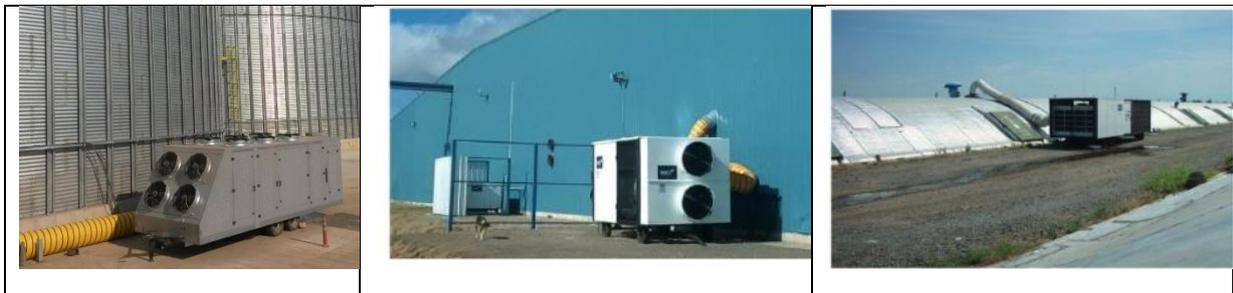
Figura 9: De izquierda a derecha, ejemplos de equipos refrigeradores de silos, cámaras y silos subterráneos.
