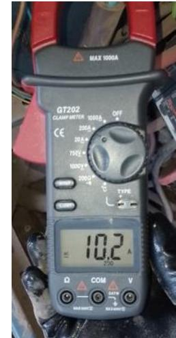
Comparando ambas mediciones, se observa una disminución de amperaje del 5,5% en carga y de un 60% en vacío.
