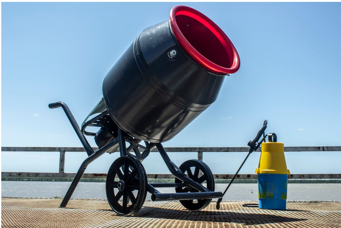
Fig 3. Máquina casera de peletización de semillas con pulverizador.
