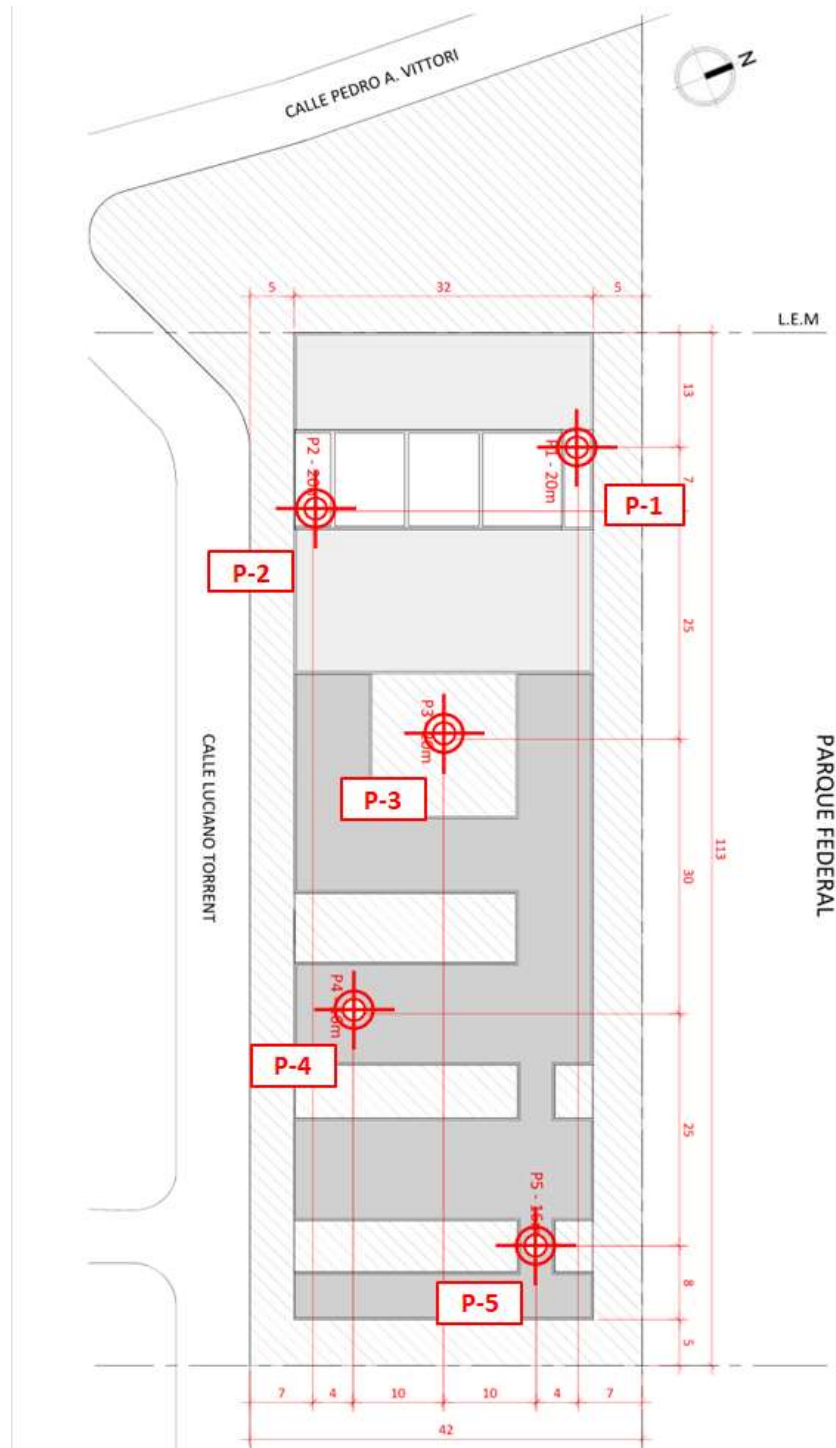
Fig. N° 4. Ubicación de las perforaciones
