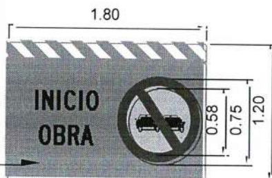
T. 1 (B)(a) INICIO OBRA EN CONSTRUCCION PROHIBICION DE ADELANTARSE
