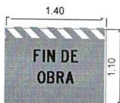
T. 1(A)(b) FIN DE OBRA EN CONSTRUCCION
