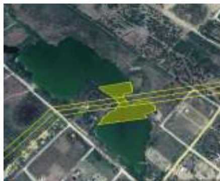
Imagen 10: Resolución cruce del préstamo para la implantación del terraplén de defensa.
