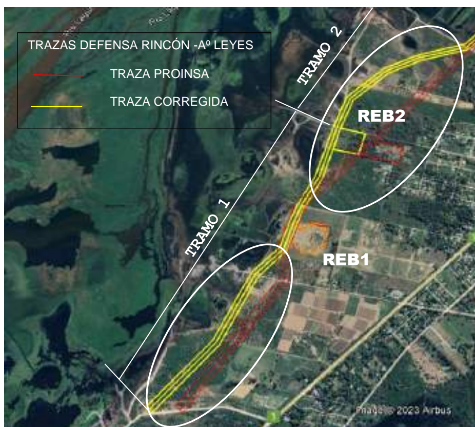
Imagen 2: Ubicación Reservoirio (REB1 y REB2) y estaciones de bombeo correspondientes (EB1 Prog. m 1350 y EB2 Prog. m 2080) en línea amarilla la nueva traza y reservorio.
