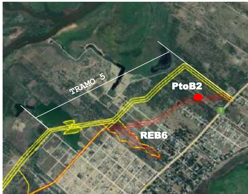
Imagen 9 : Ubicación Reservorio (REB6) y estación de bombeo correspondiente (EB6 Prog. m 8417) en línea amarilla la nueva traza, relleno del préstamo y reservorio.
