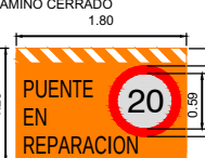
T. 16 (A)(a) PUENTE EN REPARACION
