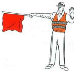
PARA DETENER EL TRÁNSITO
