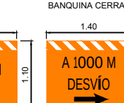
T. 1(A)(c) A 1000M. OBRA EN CONSTRUCCION
