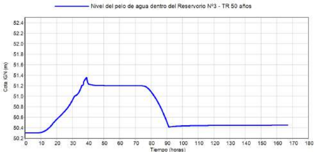
Figura N° 44: Variación de nivel dentro del reservorio para un tr de 50 años – nivel máximo disponible del reservorio 51.45 – cota de coronamiento de defensa 52.50 (m)
