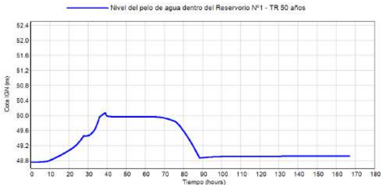
Figura Nº 40: Variación de nivel dentro del reservorio para un tr de 50 años – nivel máximo disponible del reservorio 50.21 – cota de coronamiento de defensa 52.50 (m)
