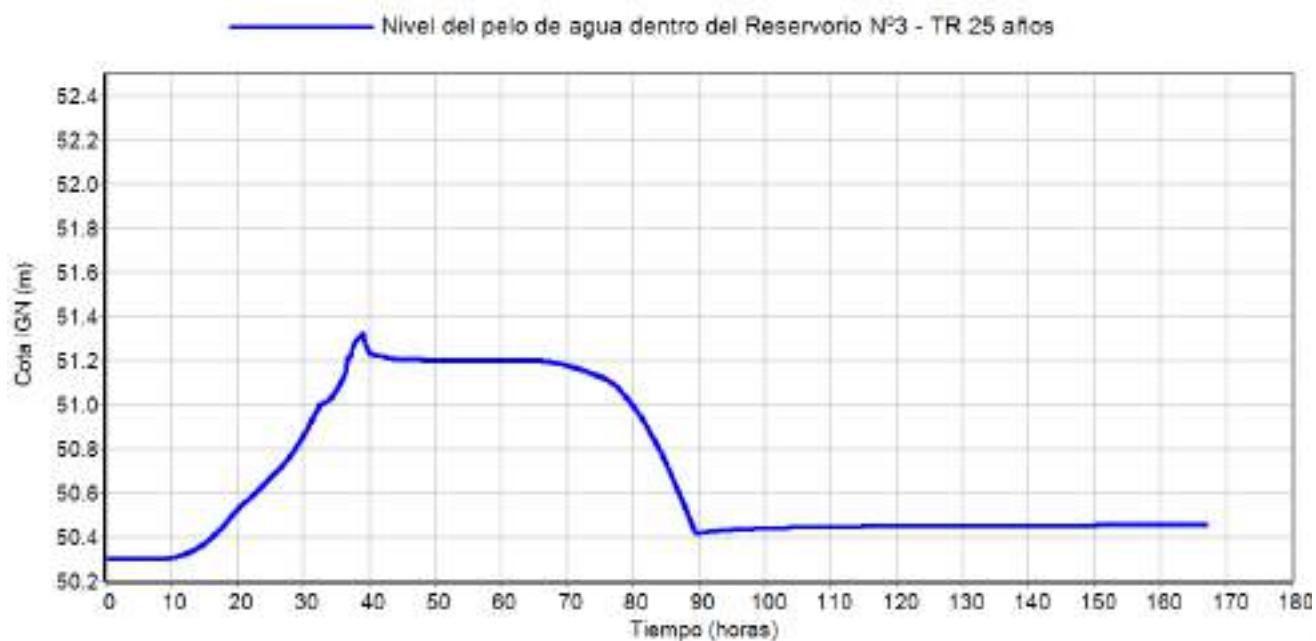
Figura N° 38: Variación de nivel dentro del reservorio para un tr de 25 años – nivel máximo disponible del reservorio 51.45 – cota de coronamiento de defensa 52.50 (m)
