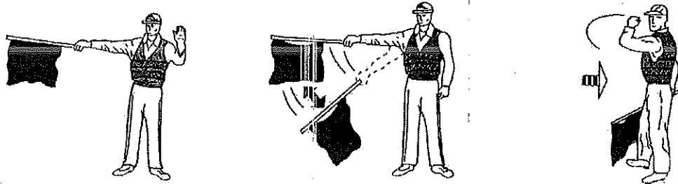
**PARA DETENER EL TRÁNSITO****PARA ALERTAR AL TRÁNSITO Y QUE DISMINUYA LA VELOCIDAD****PARA QUE CONTINUE LA MARCHA****5 ESQUEMAS DE SEÑALIZACION Y CANALIZACION****5.1 CASO 1 – ESQUEMA TIPO DE SEÑALAMIENTO TRANSITORIO CON INVASIÓN DE CALZADA (presenta pérdida de capacidad y NS con fricción marginal e intermedia)**
