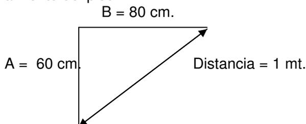
Las mediciones que aseguran el perfecto escuadramiento son: si se mide sobre una de las paredes (A) 60 cm, y sobre la otra pared (B) 80 cm, al unir ambos extremos de las dos mediciones anteriores se debe obtener una distancia de 1m
