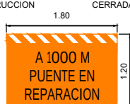
T. 16 (A)(b) PUENTE EN REPARACION
