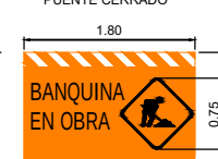
T. 14 (B)(a) BANQUINA EN OBRA
