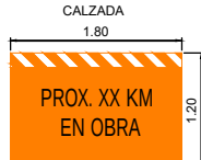
T. 10 (A)(c) PROXIMOS XXXM EN OBRA
