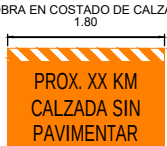
T. 10 (A)(d) PROXIMOS XXXM CALZADA SIN PAVIMENTAR
