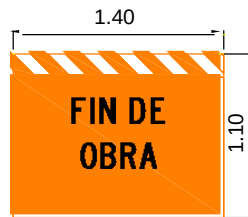
T. 1(A)(b) FIN DE OBRA EN CONSTRUCCION
