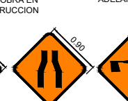
T. 4 (B) ESTRECHAMIENTO DE CALZADA (IZQUIERDA)
