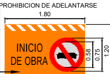
T. 1 (B)(a) INICIO OBRA EN CONSTRUCCION
