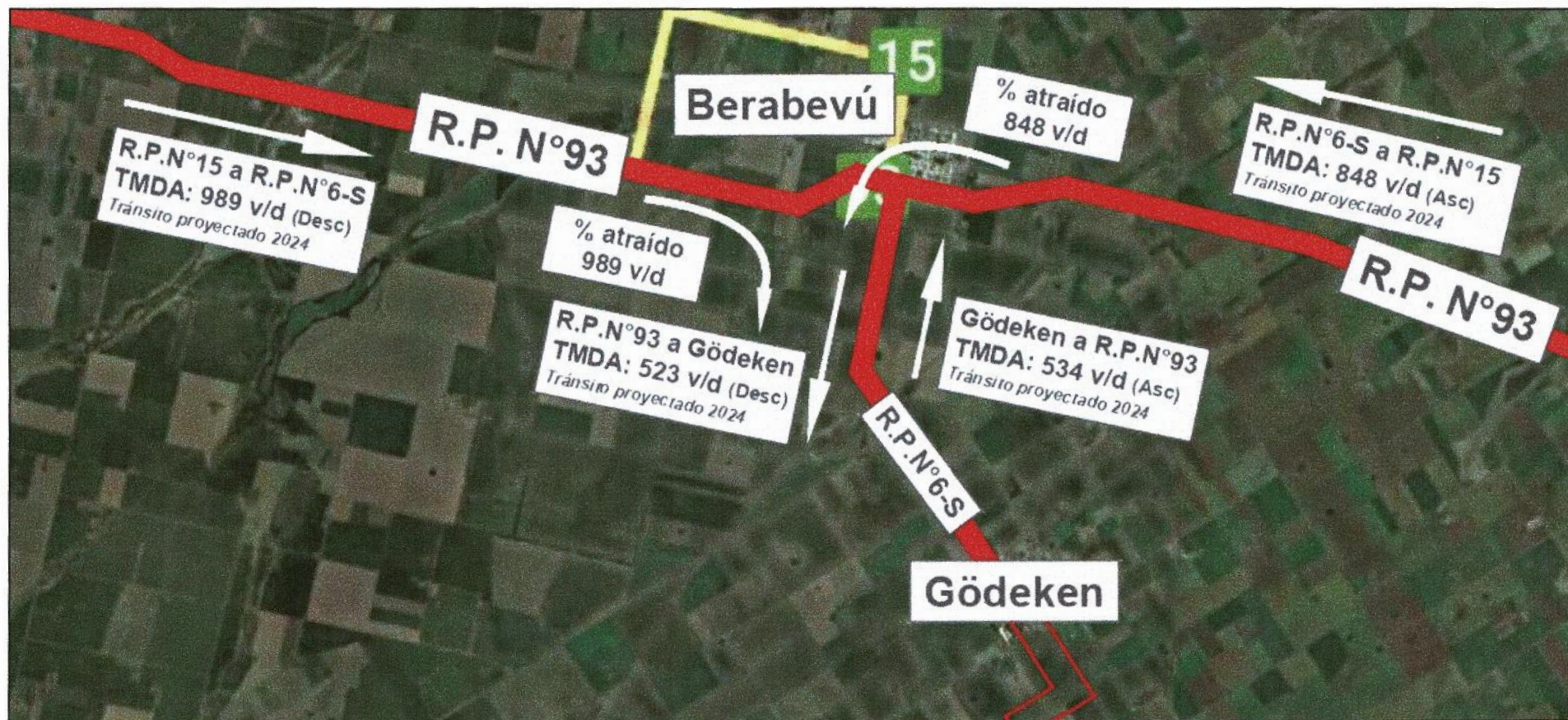
Figura 16. Esquema de flujo vehicular por la ejecución de las obras (Tramo R.P. N°93 – Gödeken)
