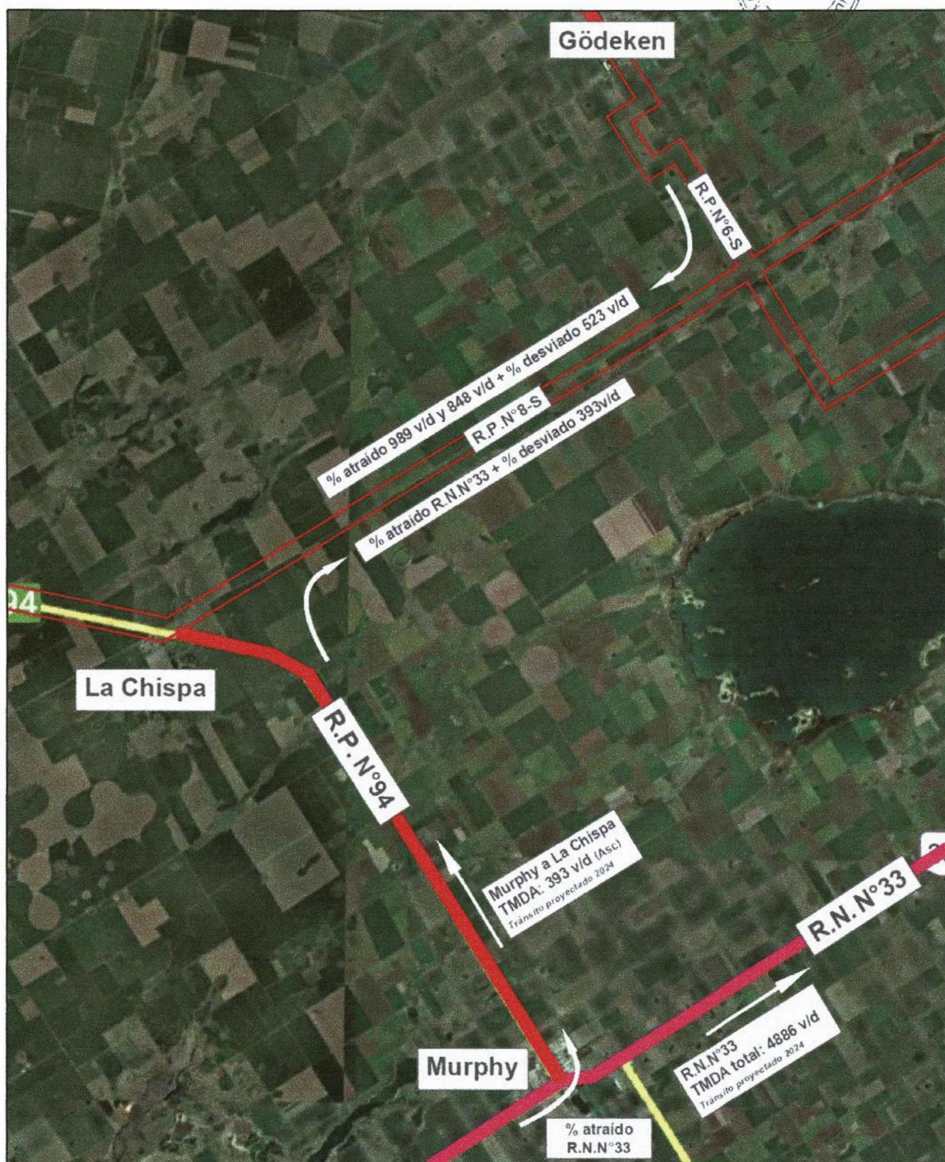
Figura 17. Esquema de flujo vehicular por la ejecución de las obras (Tramo Murphy – Gödeken)
