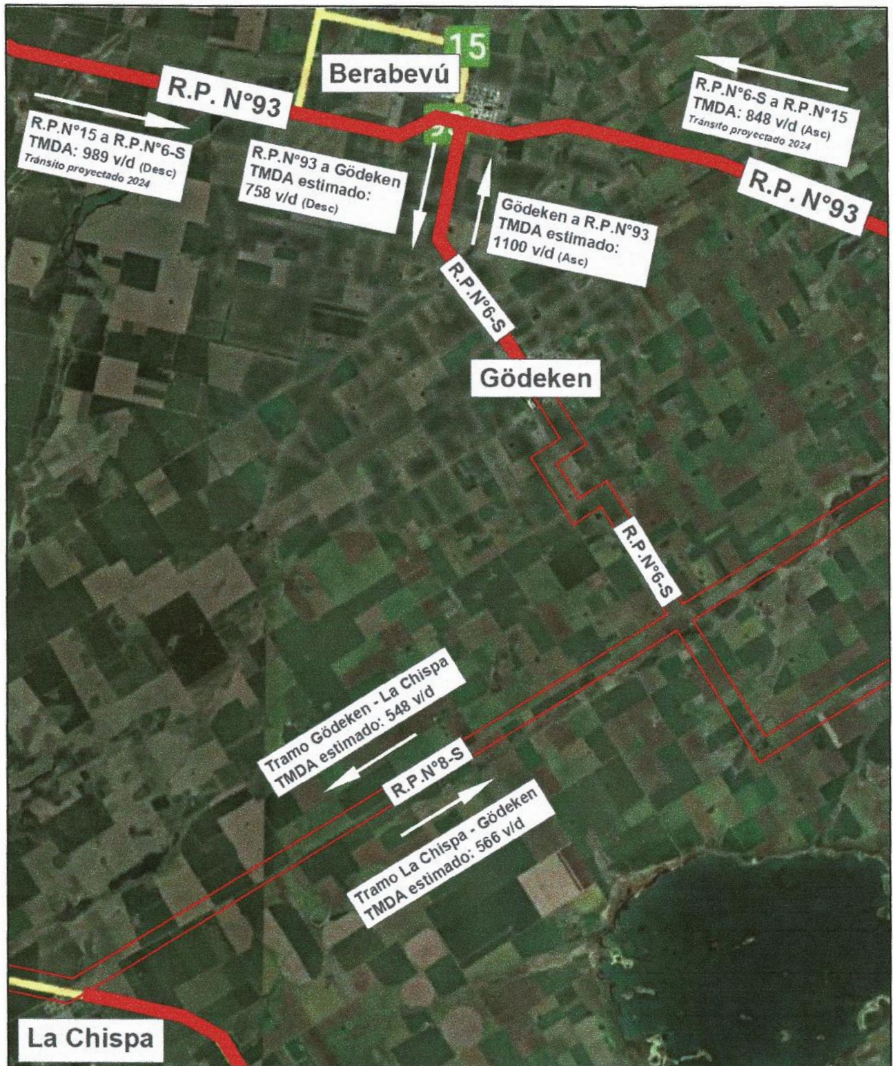
Figura 18. T.M.D.A. estimados AÑO 2024 con obras habilitadas
