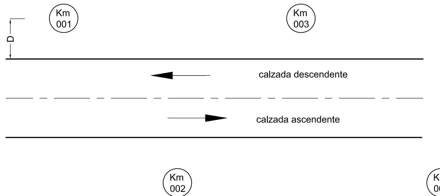
D = Distancia borde de calzada a eje mojon (1.80m a 4.00m)
