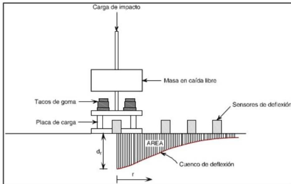
El ensayo consiste en medir el desplazamiento vertical de varios puntos de la superficie de un pavimento, midiendo estas deformaciones desde el centro de una placa circular rígida, sometida a un pulso de carga dinámica de magnitud predefinida, de forma de determinar el cuenco de deformaciones para un eje longitudinal al pavimento.
