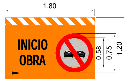
T. 1 (B)(a) INICIO OBRA EN CONSTRUCCION PROHIBICION DE ADELANTARSE
