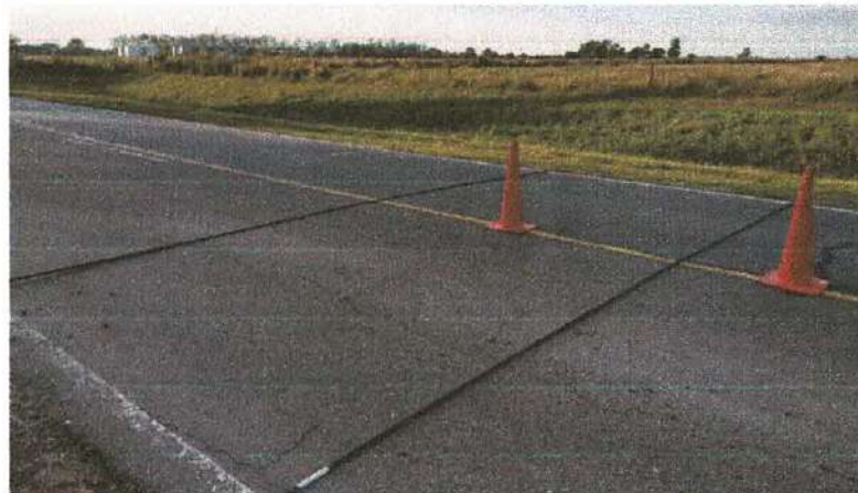
Figura 12. Contador automático con mangueras
