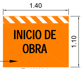
T. 1(A)(a) INICIO DE OBRA EN CONSTRUCCION
