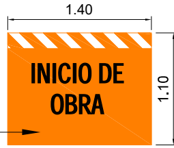
T. 1(A)(a) INICIO DE OBRA EN CONSTRUCCION
