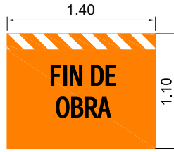
T. 1(A)(b) FIN DE OBRA EN CONSTRUCCION
