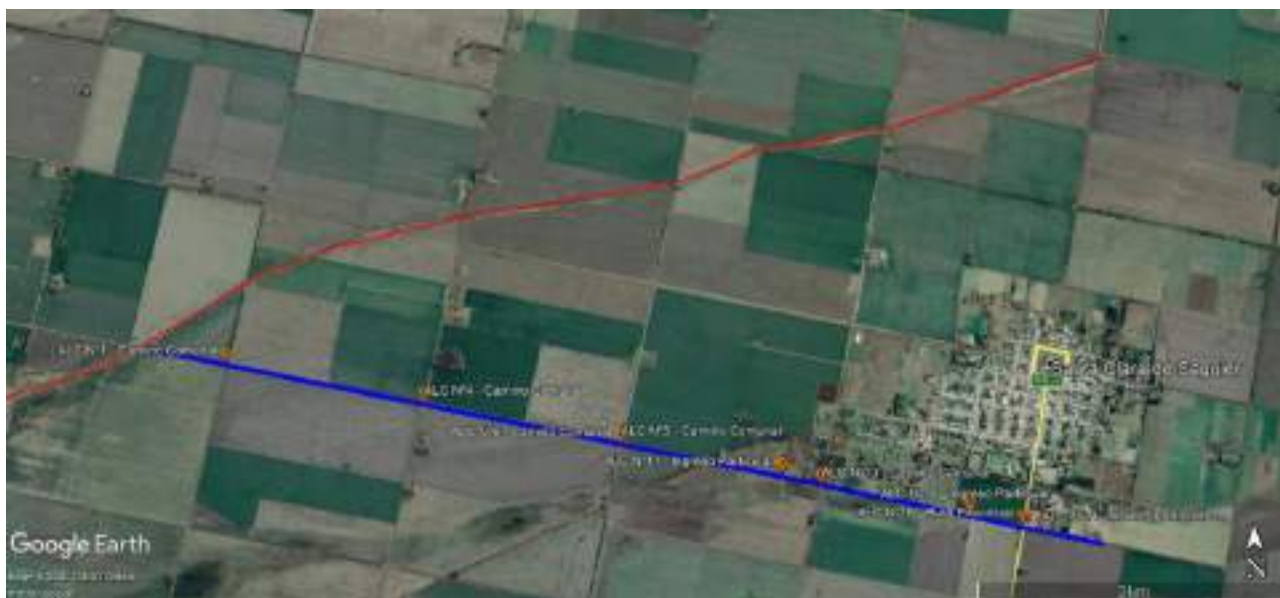
Imagen 3: Ubicación de alcantarillas existentes en traza rural.
