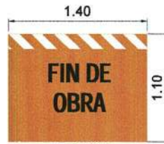
T. 1(A)(b) FIN DE OBRA EN CONSTRUCCION
