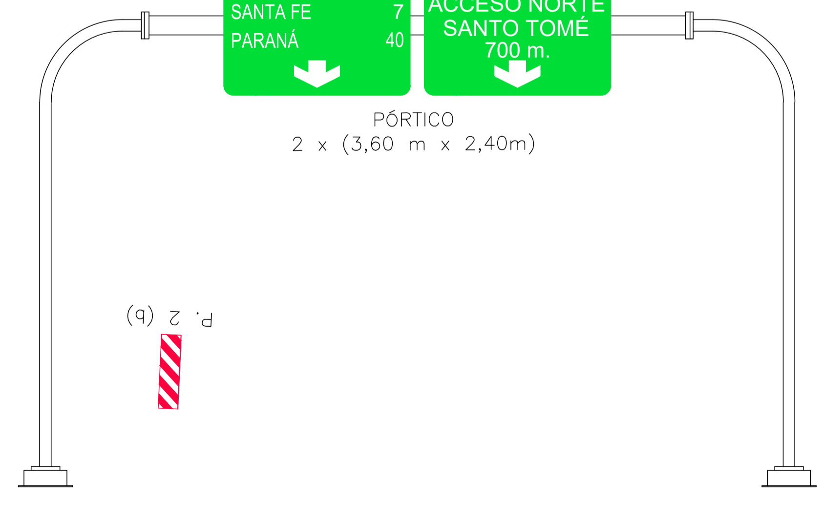
PÓRTICO UBICADO SOBRE AUTOPISTA A 1000m DE NARIZ DE RAMA DE ENTRADA A AU.
