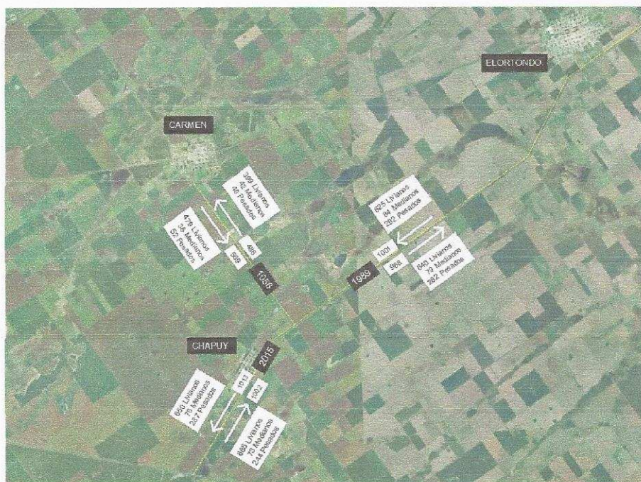
Figura 3: Estimación del T.M.D.A en las secciones analizadas.
